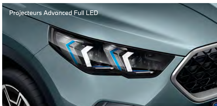
Projecteurs Advanced Full LED Répartition variable de la lumière et feux de route anti-éblouissement permanents. Fonctions éclairage d'autoroute et éclairage par mauvais temps.
