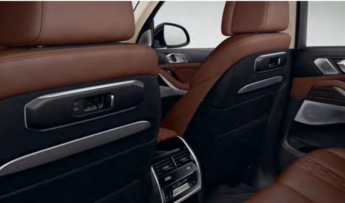
Travel & Comfort System Supports intégrés au dos des sièges avant pour fixer des tablettes, cintres, crochet pour sacs, accessoires etc. Inclus un port USB-C.
