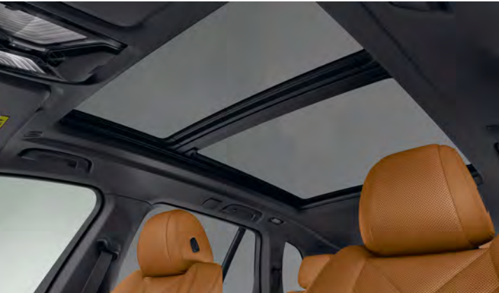
Toit ouvrant panoramique en verre Toit ouvrant en deux parties, avec actionnement électrique et protection contre le soleil et déflecteur de vent. Ouverture et fermeture possible avec la clé.
