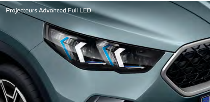
Répartition variable de la lumière et feux de route anti-éblouissement permanents. Fonctions éclairage d'autoroute et éclairage par mauvais temps.
