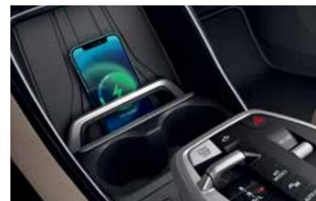
**La recharge sans fil par induction** permet de recharger le mobile sans câble mais aussi de le coupler par induction à l'antenne de toit. peut être utilisée pour tous les téléphones mobiles équipés de la technologie de recharge Qi.
