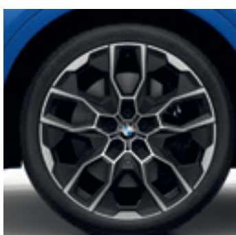
Jantes 22" à rayons doubles style 913 M Pneus avant : 275/40 R 22 Pneus arrière : 315/35 R 22.
