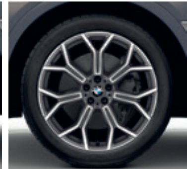
Jantes 21" style 753 Ferric Grey à rayons en Y bicolores Pneumatiques mixtes : 285/45 R21 permettant le roulage à plat.
