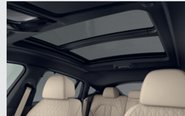
Toit ouvrant panoramique en verre Toit ouvrant en deux parties, avec actionnement électrique et protection contre le soleil et déflecteur de vent. Ouverture et fermeture possible avec la clé.
