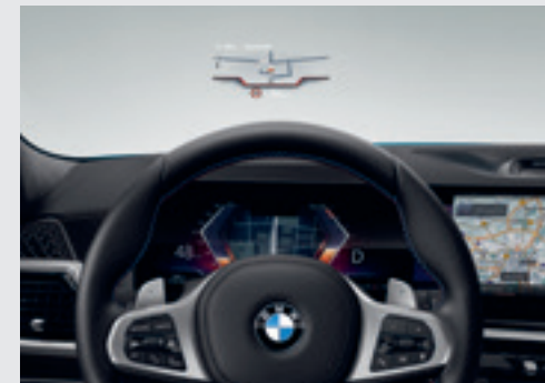
Affichage Tête Haute avec Réalité augmentée Affiche dans le champ de vision du conducteur les informations de conduite importantes : vitesse, navigation, limitation de vitesse, contenus médias...
