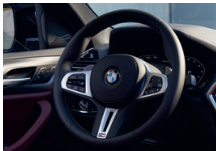
Volant chauffant La jante du volant est amenée en quelques instants à une température agréable en actionnant un bouton placé sur le volant.
