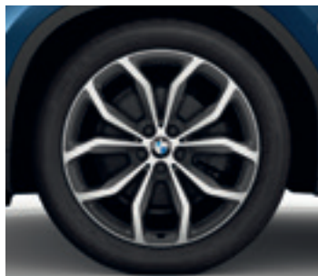
□ Jantes en alliage 20" style 695 à rayons en Y 8 J x 20 / pneus 245/45 R 20 9,5 J x 20 / pneus 275/40 R 20
