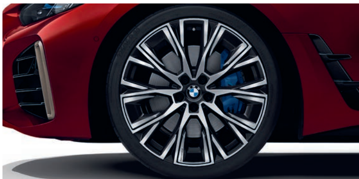
Jantes en alliage léger 20" (48 cm) style 862 I à rayons en Y, bicolores avec pneumatiques mixtes : Avant : 245/35 R20 - Arrière : 255/35 R20
