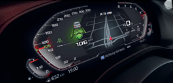
Assisted Driving View Pour optimiser votre interaction avec vos aides à la conduite, vous visualisez en temps réel la situation perçue par vos assistants et les actions qu'ils planifient.
