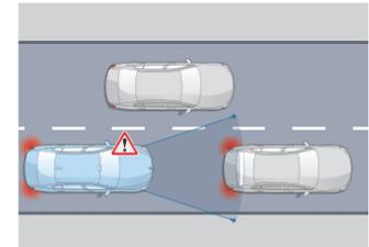
**Détection de collision avant avec freinage**
