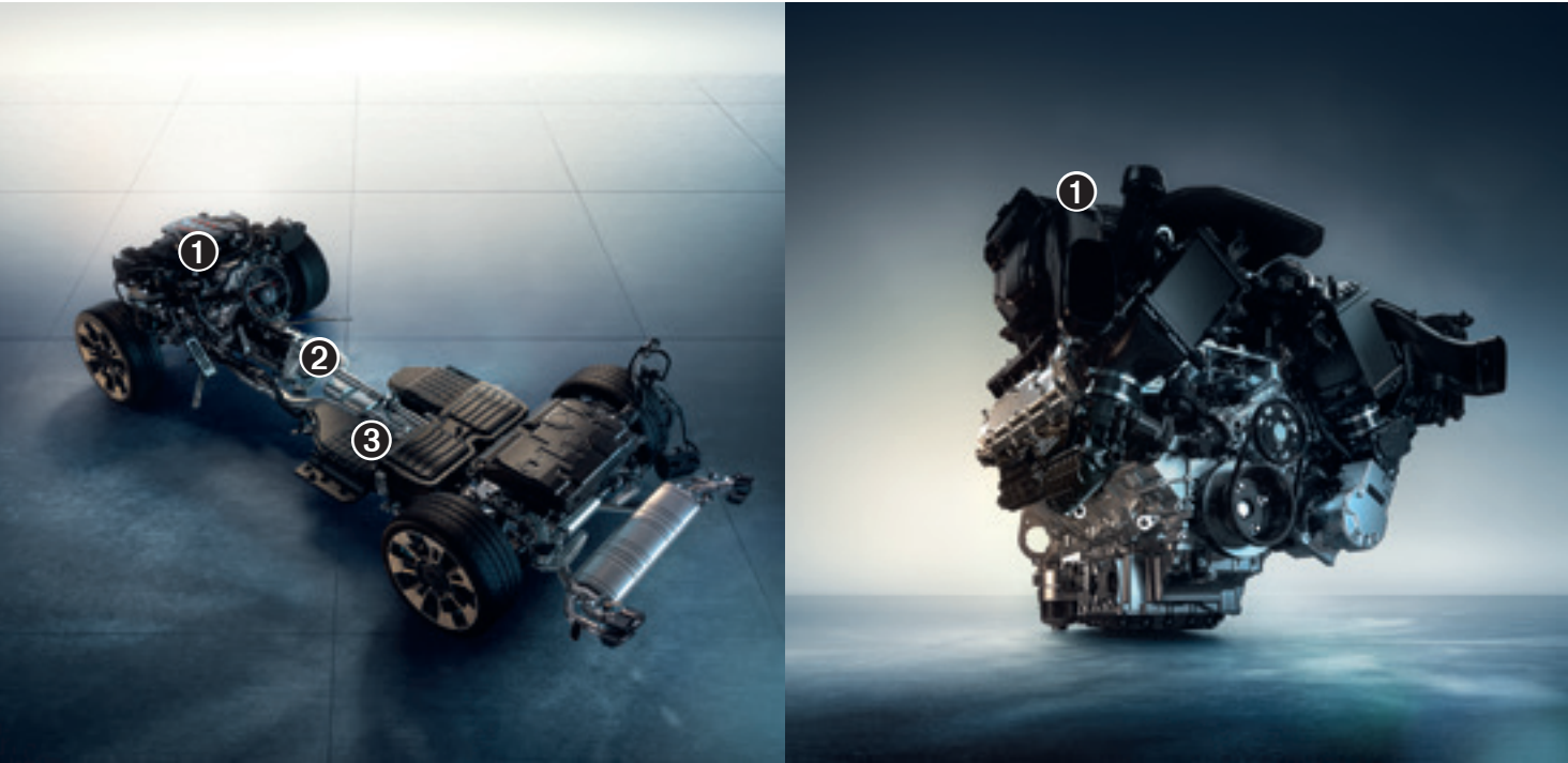
Architecture de la motorisation M HYBRID V8 avec : 1 Moteur M TwinPower Turbo V8 - 4,4 litres 2 Moteur électrique intégré à la transmission 3 Batterie Lithium-ion haute tension intégrée en soubassement
