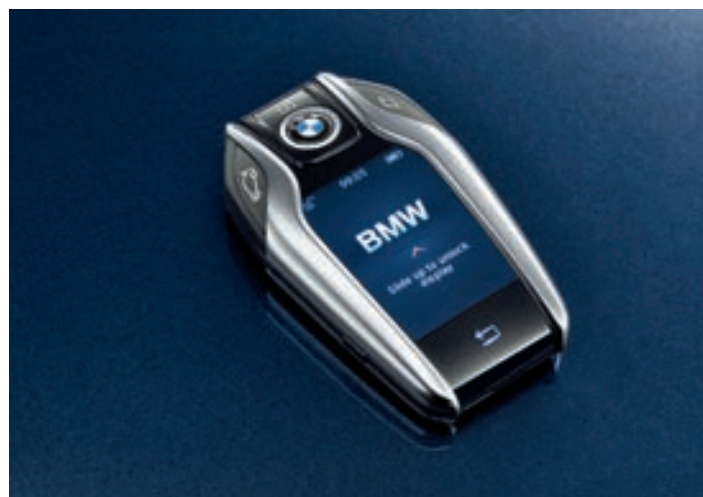
BMW Display Key Via son écran tactile, elle indique différents statuts de la voiture et commande certaines fonctions, comme le chauffage auxiliaire.
