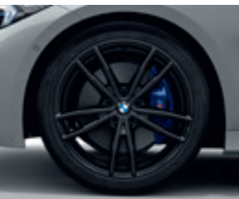
Jantes en alliage léger 19" (48 cm) style 791 M JetBlack à rayons doubles avec pneumatiques mixtes / RSC Pneumatiques avant : 225/40 R 19 / arrière : 255/35 R 19
