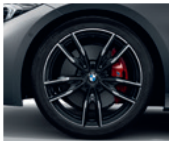
Jantes en alliage léger 19" (48 cm) style 792 M JetBlack bicolores à rayons doubles avec pneumatiques mixtes Performance - Pneumatiques avant : 225/40 R 19 / arrière : 255/35 R 19
