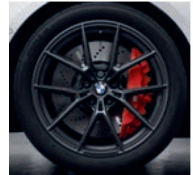
Jantes forgées BMW M Performance 19" à l'avant et 20" à l'arrière à rayons en Y style 963 M Grises.
