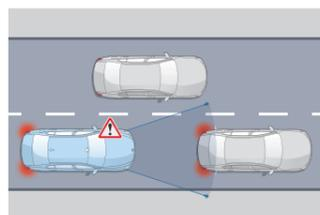
**Détection de collision avant avec freinage**
