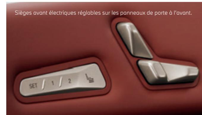
Sièges avant électriques réglables sur les panneaux de porte à l'avant.
