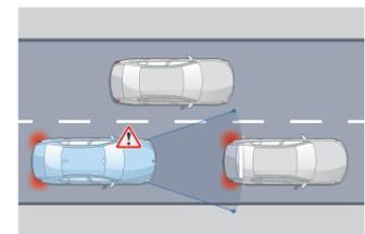
**Détection de collision avant avec freinage**
