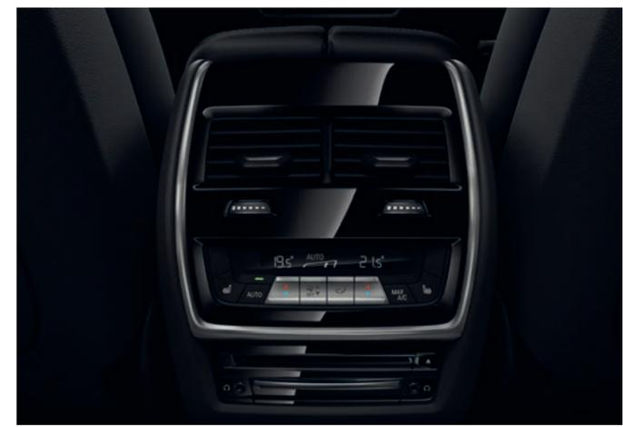
**La climatisation automatique 4 zones** inclut des fonctionnalités étendues en plus des fonctionnalités de la climatisation automatique 2 zones ainsi que deux aérateurs sur les montants centraux. Par ailleurs, les passagers arrière bénéficient d'un réglage individuel via une commande séparée avec affichage.
