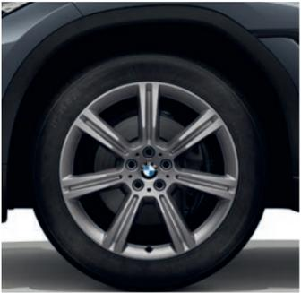
Alliage léger 20" style 736 à rayons en étoile avec pneumatiques mixtes 9 J x 20 / pneus 275/45 R 20
