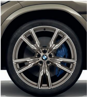
Alliage léger 22" style 747 M bicolores à rayons en V. Pneumatiques mixtes : 9,5 J x 22 / pneus 275/35 R 22
