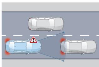
**Détection de collision avant avec freinage**
