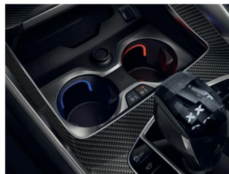
**Les porte-boissons thermorégulés** en console centrale, maintiennent les boissons au chaud ou au frais. L'éclairage d'ambiance signale la fonction activée, en bleu pour froid ou en rouge pour chaud.
