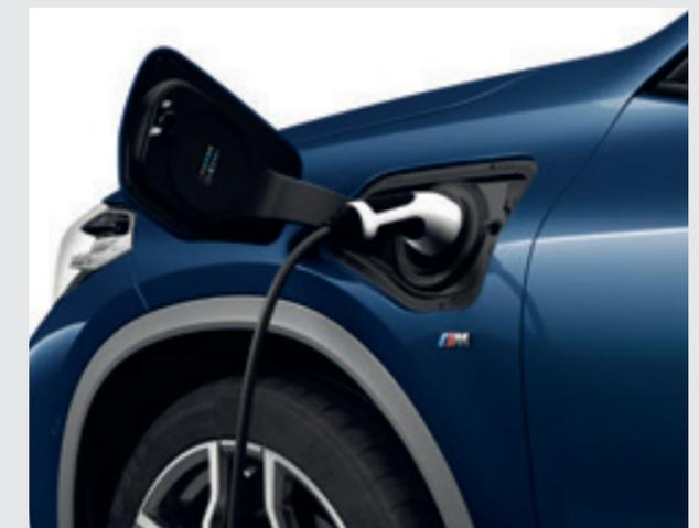
Une bague d'étanchéité spéciale protège la prise pour recharge externe. L'anneau lumineux à LED qui l'entoure indique le niveau de charge de la batterie.
