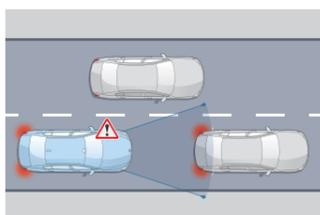
**Détection de collision avant avec freinage**
