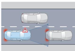
**Détection de collision avant avec freinage**
