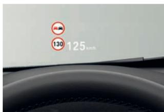
**Speed Limit Info** vous évite d'être pris en défaut dans votre conduite. Pour plus d'efficacité, l'affichage des limitations de vitesse et des interdictions de dépassement se fait à la fois sur le tableau de bord et dans l'affichage Tête Haute HUD en couleur.
