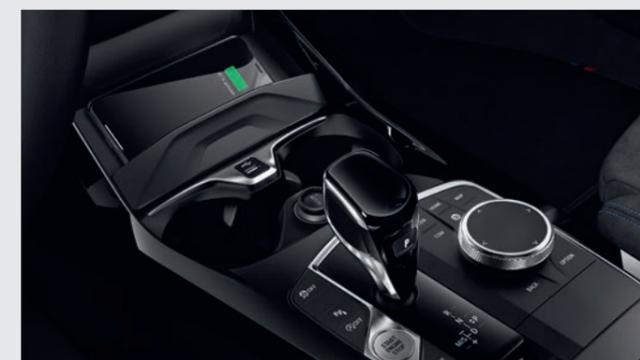
La plaque de **recharge sans fil par induction** permet de recharger le mobile sans câble et de le coupler par induction à l'antenne de toit. Peut être utilisée pour tous les appareils équipés de la technologie de recharge Qi.
