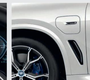
**La prise de recharge** est protégée par une bague d'étanchéité. L'anneau à LED qui l'entoure indique le niveau de charge de la batterie.
