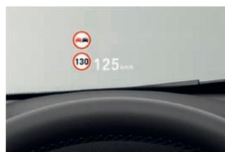
**Speed Limit Info** vous évite d'être pris en défaut dans votre conduite. Pour plus d'efficacité, l'affichage des limitations de vitesse et des interdictions de dépassement se fait à la fois sur le tableau de bord et dans l'affichage Tête Haute HUD en couleur (équipement en option).
