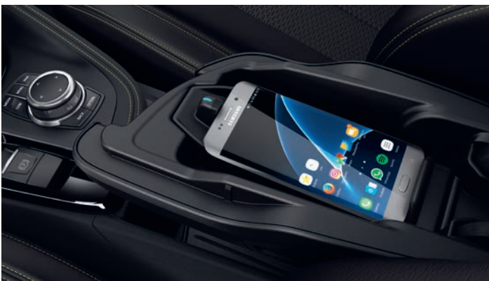
La connectivité avancée sans fil avec recharge par induction propose un pack de téléphonie complet avec Bluetooth et préparation pour hotspot Wi-Fi.
