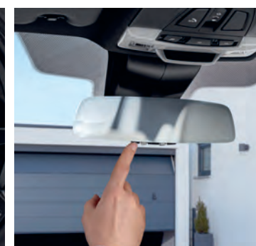
Rétroviseur avec télécommande porte de garage intégrée. Le rétroviseur intérieur sans cadre dispose d'une télécommande universelle intégrée pour piloter les portails et portes de garage.
