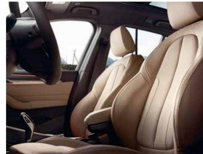
Les sièges se distinguent par une assise réglable en longueur et des joues d'assise et de dossier plus hautes que sur les sièges de série, optimisant l'ergonomie et le maintien latéral en virages à allure soutenue.
