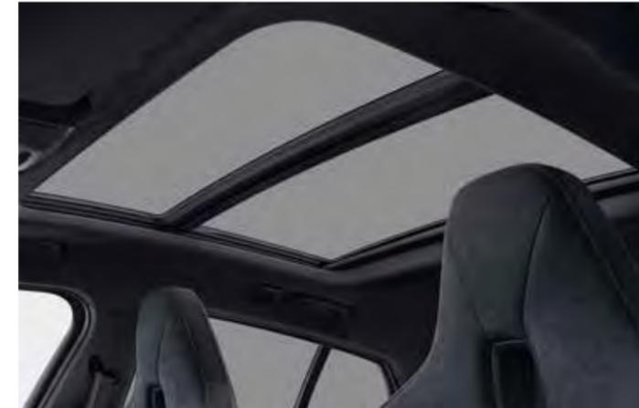
**Toit panoramique en verre électrique**, coulissant et entrebâillable à l'avant, avec pare-soleil, déflecteur et ouverture Confort via la clé radiocommandée.
