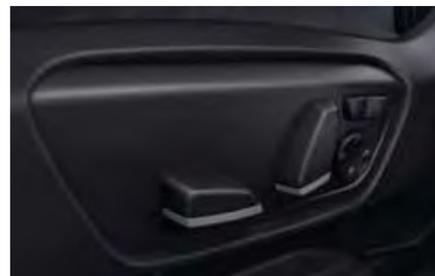
L'option **Sièges avant électriques** permet d'amener les sièges dans les positions souhaitées et de mémoriser celles du siège conducteur et des rétroviseurs extérieurs.
