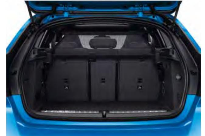
Le **Pack compartiment à bagages** comprend une sangle, un filet noir, une prise 12 V, une fonction Cargo (dossiers de banquette arrière en position droite) et un seuil de chargement en inox.
