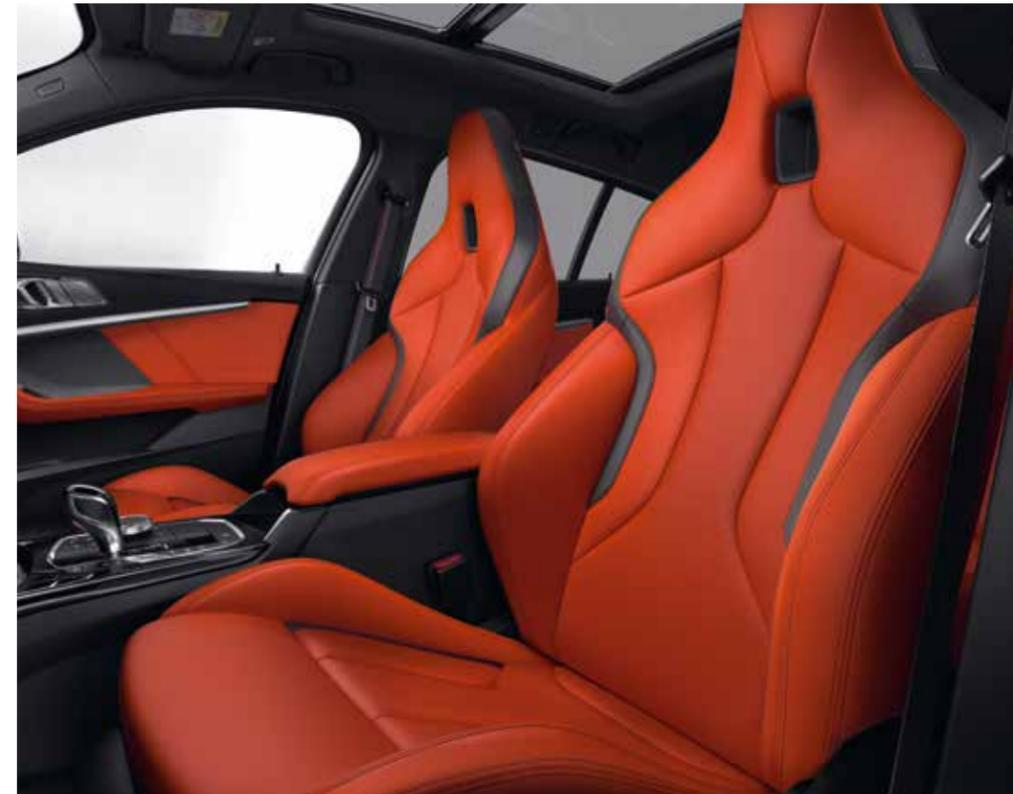
**Les Sièges M Sport** avec appuis-tête intégrés, assise basse et flancs hauts offrent un meilleur maintien même dans les enchaînements de virages rapides. Les sièges peuvent de plus être adaptés au gabarit de chacun grâce à un réglage intégré de la largeur du dossier.
